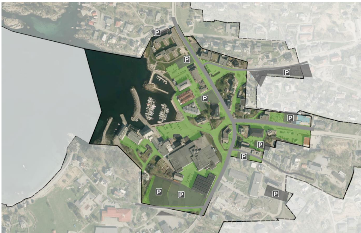
Figur 4-7 - Kartskissa viser at mykje av dagens trafikkareal markert med grønt kan bli frigjort dersom ein strammar opp gatestrukturen og strukturerer og samlar parkeringsplassane.
