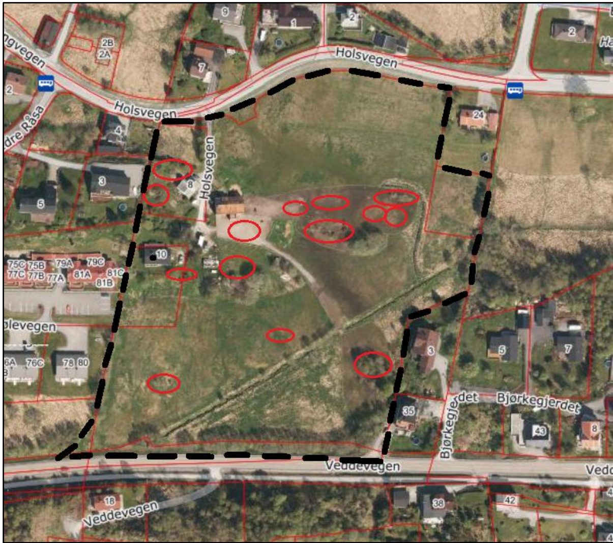
Figur 17 Flyfoto over viser lokaliseringer med synlig fjell i dagen for det fremtidige byggeområdet.
