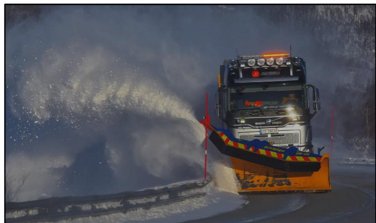
Figur 73 Snøbrøyting over vegrekkverk.
