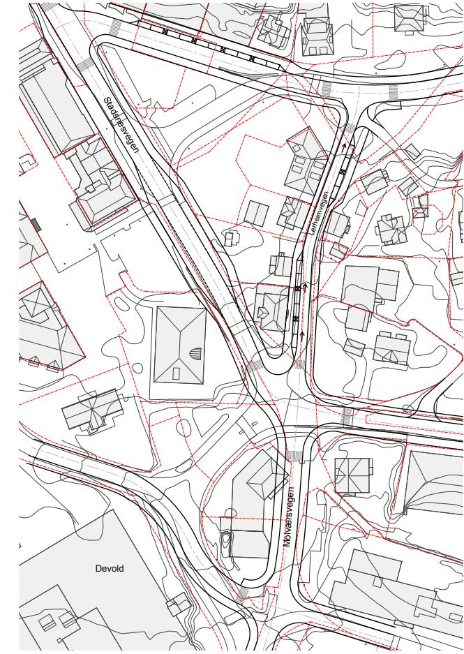
Figur 8-7 Alternativ vegføring Molværvegen, x-kryss. Figuren viser også omlegging av Fyllingvegen. III: Norconsult
