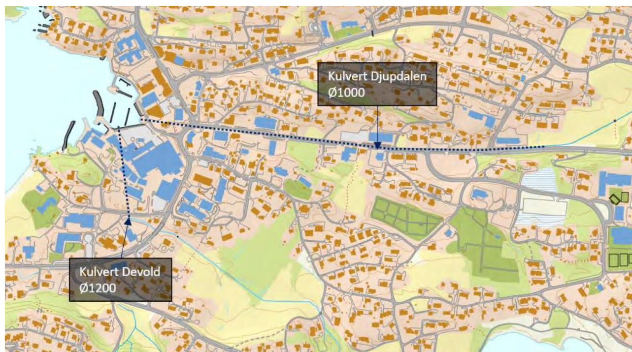
Figur 10: Bekkelukkingar som kan vere underdimensjonerte for overvasshandtering. [1]
